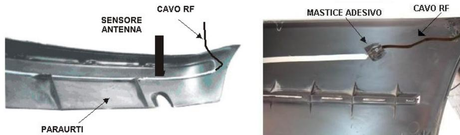
**d) Collegare il cavo RF al sensore antenna. Si consiglia di rivestire e bloccare la connessione con il mastice adesivo fornito nel kit facendo una forte pressione.** Se la temperatura ambiente è inferiore a 10° si consiglia di **riscaldare il mastice adesivo e la zona di applicazione.**
